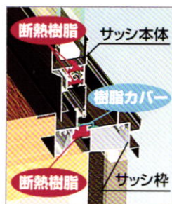
サッシ本体とサッシ枠に組み込まれた断熱樹脂が結露をおさえる「ドライ&ドライ」
